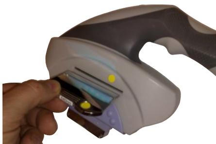
Lo speciale manipolo ergonomico di StarLight permette la sostituzione rapida dei filtri per lo svolgimento dei vari trattamenti personalizzati. Un piccolo display, installato al suo interno, indica il numero degli spot effettuati.
